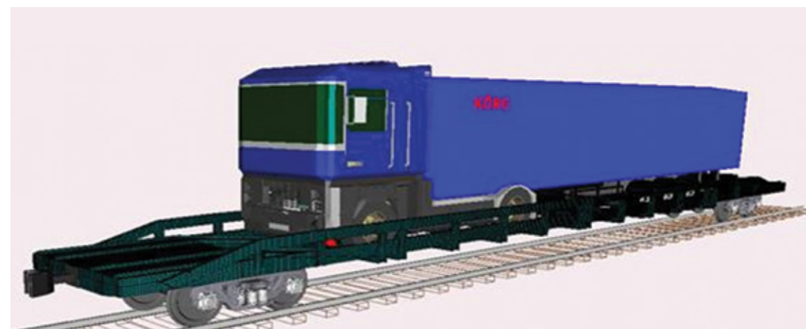
图12. 设计完成的车厢平车及带安装其上的汽车列车。
