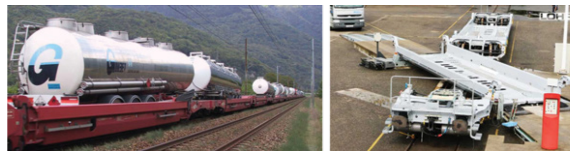
Рис. 5. Платформы с заниженным уровнем пола для контрейлерных перевозок.
