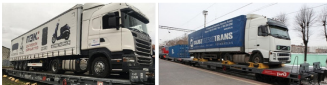
图 13. 带有桁架结构的平车。
