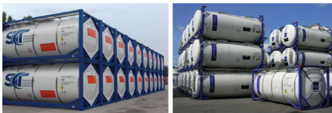
Рис. 43. Танк-контейнеры для перевозки различных жидкостей и сжиженных газов
