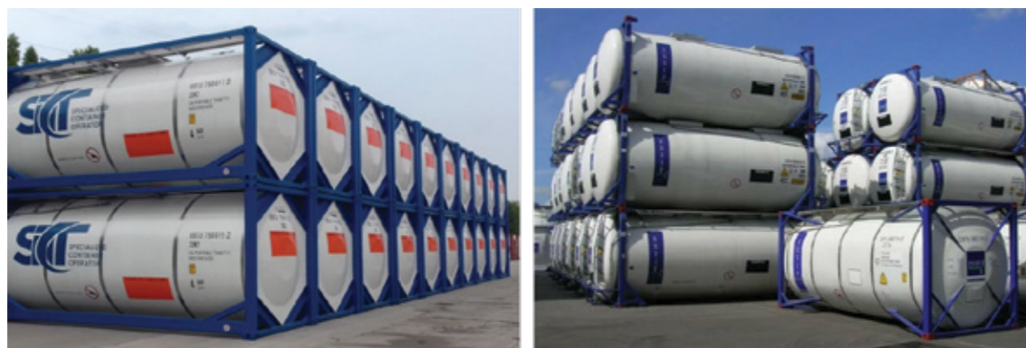
图43. 用于运输各种液体和液化气体的罐式集装箱。
