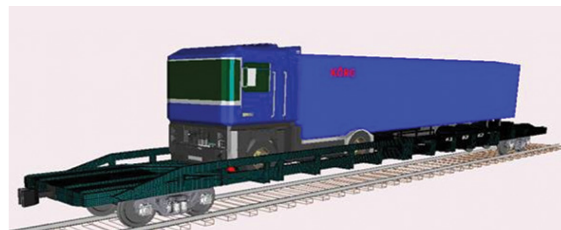
Рис. 12. Спроектированный вагон-платформа с установленным на нем автопоездом
