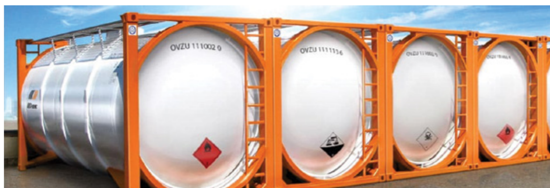
Рис. 42. Танк-контейнеры для перевозки различных жидкостей и сжиженных газов
