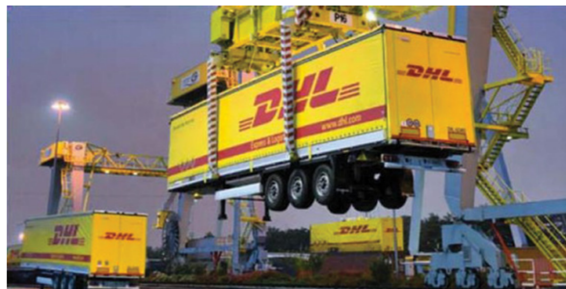
图19. “吊装 (Lo-Lo)”技术。
