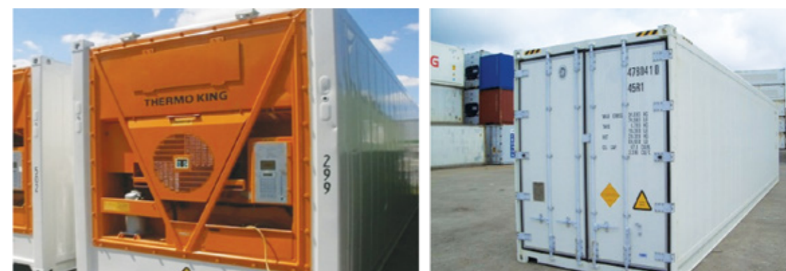
Рис. 40. Рефрижераторные контейнеры 40 футов
